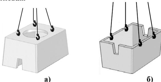
Рис. 8. Строповка элементов «ККСр-2-10(80)»: а – верхнего элемента; б – нижнего элемента.
