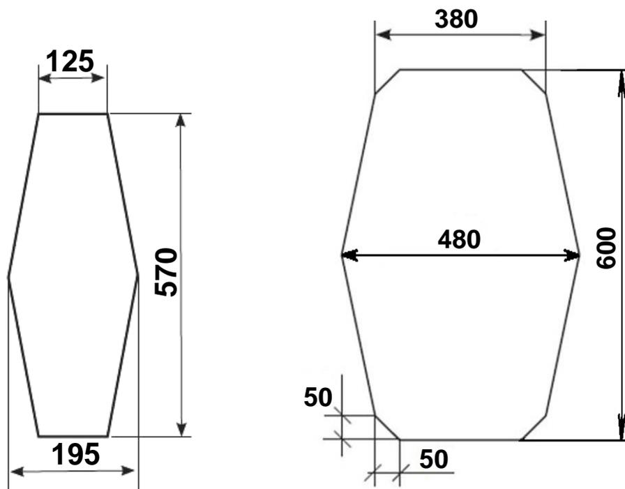
**Рис. 2.2. Размеры технологического отверстия и участка с тонкой
