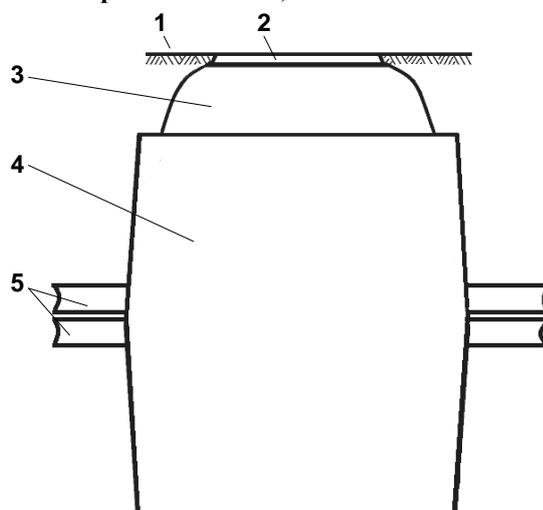
Рис. 2. Колодец «ККСр-2-10(80)» как подземное сооружение:
