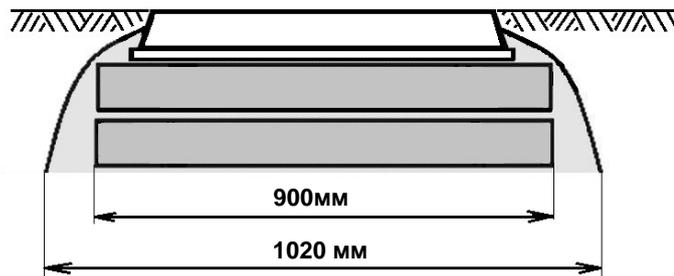
Рис. 12. Размеры (диаметры) опорных колец типа КО и бетонной обмазки. Вид на колодец «ККСр-2-10(80)» сбоку.
