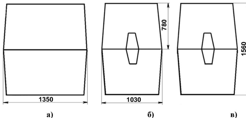
Рис. 6. Габаритные размеры колодца «ККСр-2-10(80)»:
