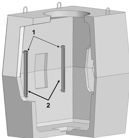
Рис. 3.1. Установка кронштейнов «ККП-60» в колодце «ККСр-2-10(80)»:
